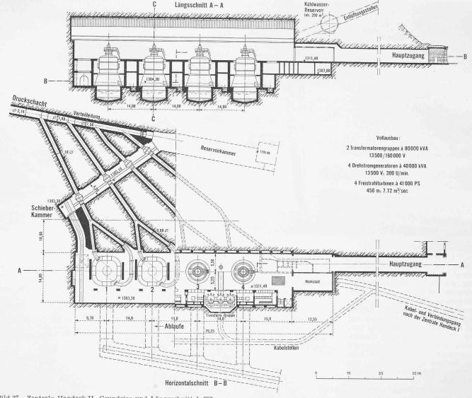
Bild 27. Zentrale Handeck II, Grundriss und Längsschnitt 1:800
