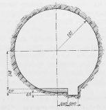
Bild 14. Stollen Rätherichsboden-Handeckfluh, Querschnitt 1:100
