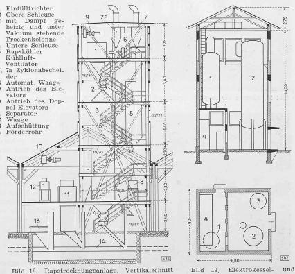
durch das Gebäude, Masstab 1:200 Speicheranlage, Masstab 1:300
