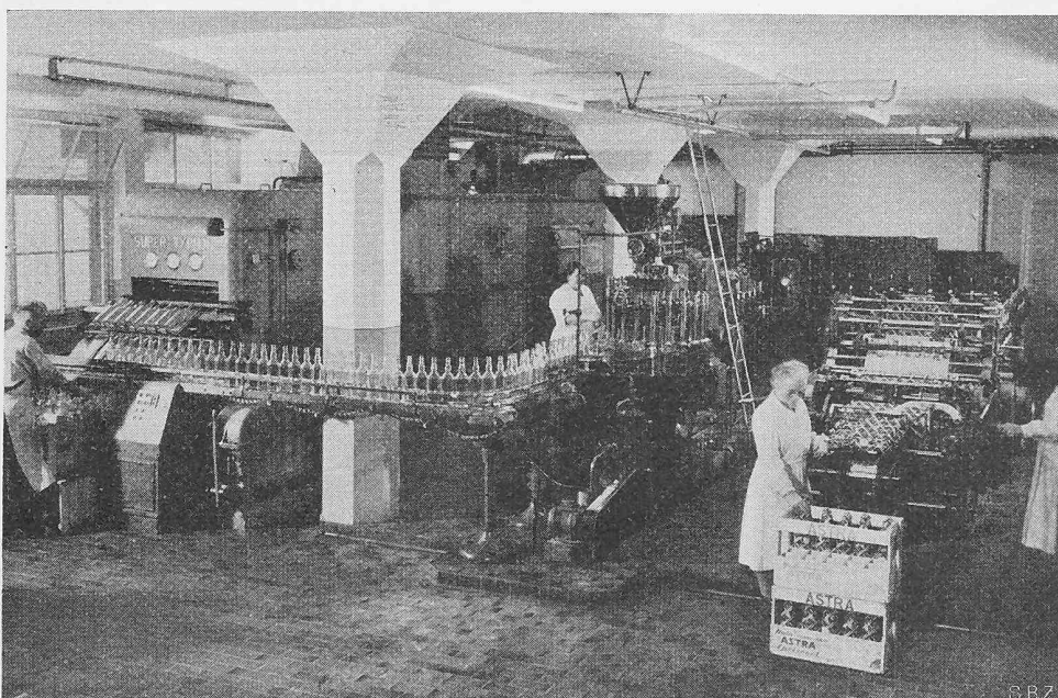
Bild 30. Links Flaschenreinigungsmaschine, daneben Abfüllmaschine, rechts Verpackung
