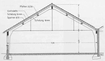
Bild 26. Fettabfüllerei; Querschnitt durch das Gebäude, Masstab 1:200
