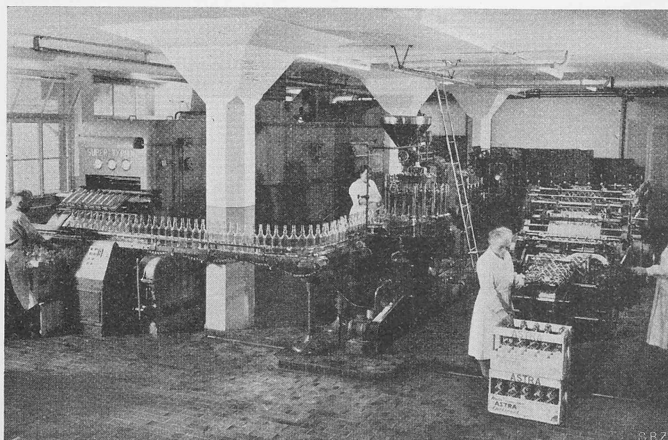
Bild 30. Links Flaschenreinigungsmaschine, daneben Abfüllmaschine, rechts Verpackung
