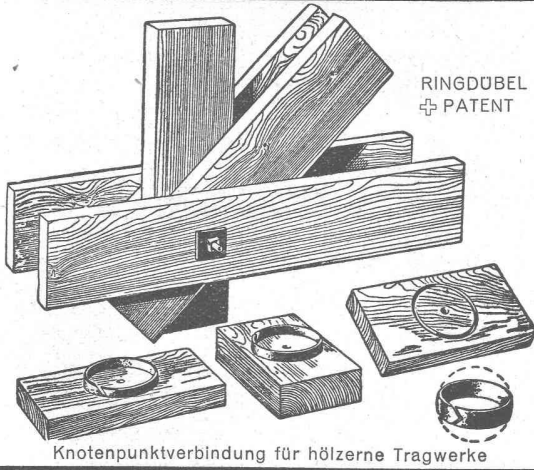
Knotenpunktverbindung für hölzerne Tragwerke
