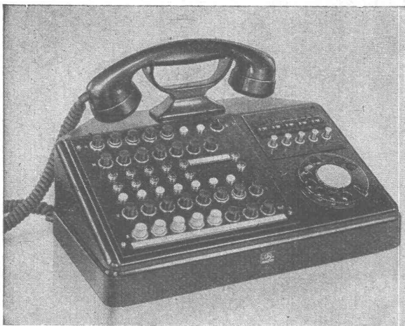
Vermittlungsstation für Telephonanlagen mit 5 Amtsleitungen.
