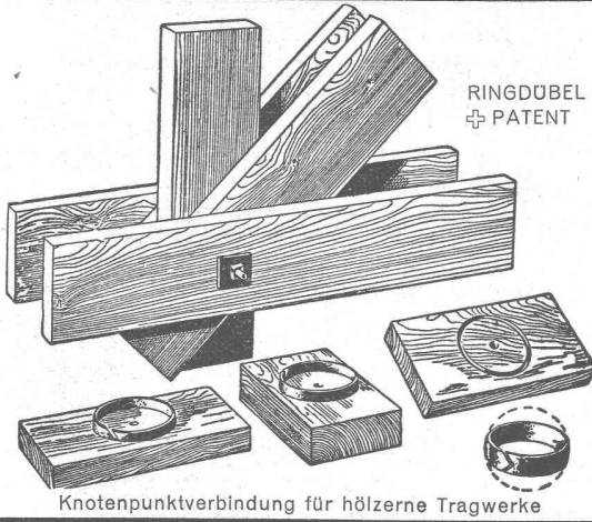
Knotenpunktverbindung für hölzerne Tragwerke
