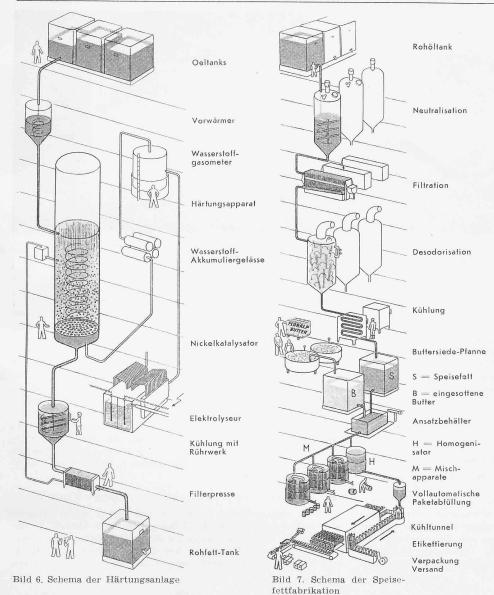
durch Filtrieren in Filterpressen gereinigt werden. Nach der Reinigung wird das Rohöl in grossen, im Freien aufgestellten Behältern gelagert.
