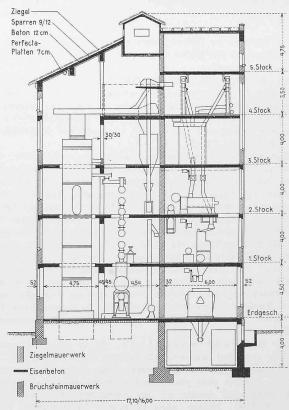
Bild 10. Nachpress- und Extraktionsanlage, Vertikalschnitte durch das Gebäude, Masstab 1:300
