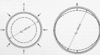
Ueberlagerungshöhe 43 m;  $D_0$  = 220 cm (Anfang), Eistemperatur rd. 0° (Druckschmelzpunkt). Messperiode 9. 8. 49 bis 2. 8. 50. Mittlere spez. Verkürzung des Durchmessers pro Tag 0.68%.
