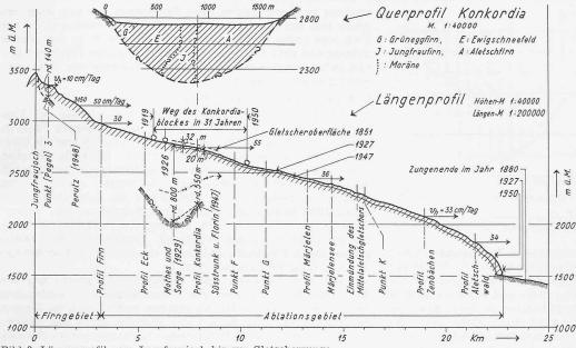
Bild 2. Längenprofil vom Jungfraujoch bis zur Gletscherzunge
