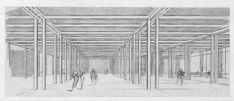
Bild 13. Innenperspektive der Hallen im Erdgeschoss. Die vielen im Messebetrieb notwendigen Leitungen werden zwischen den Flanschen der doppelten Stahlstützen sichtbar geführt.
