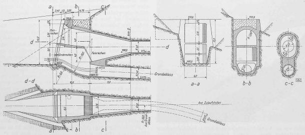
Bild 13. Rätherichsboden, Grundablass und Stolleneinlauf 1:500
