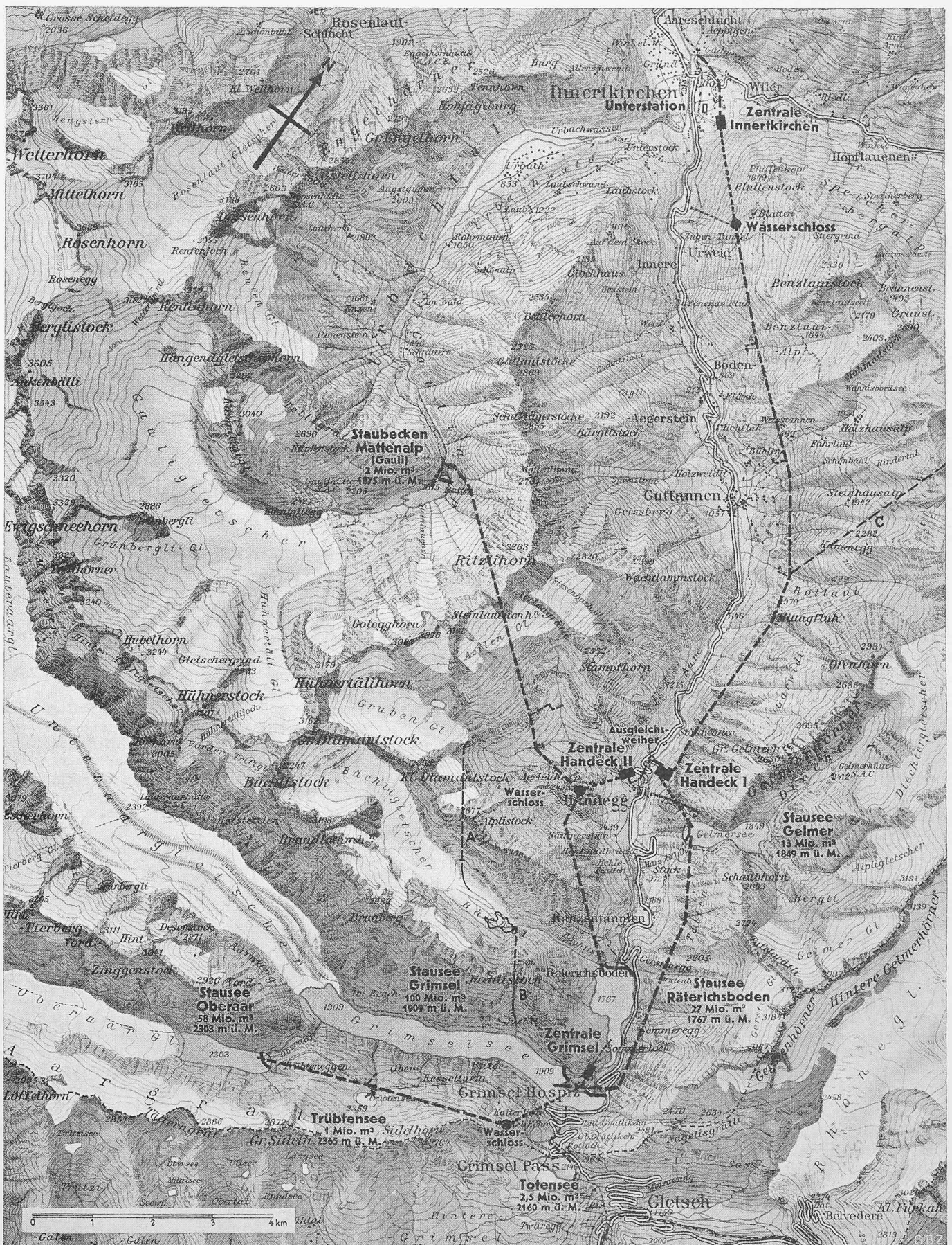
Bild 1. Wasserkraftanlagen im Oberhasli, Uebersichtskarte 1:85 000, reproduziert mit Bewilligung PTT, KWO und Kümmerly & Frey, Bern. A Ueberleitung Grubenbach, B Ueberleitung Bächlisbach, C Zuleitung der Trift- und Gadmenwasser
