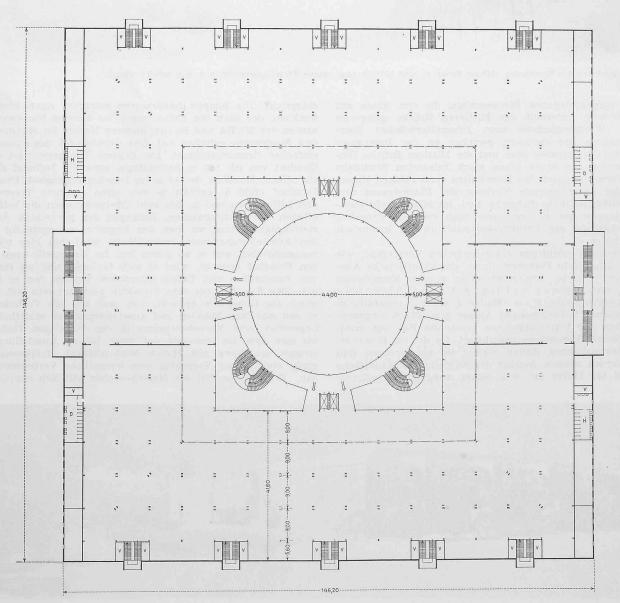
Bild 9. Obergeschossgrundriss, 1:1000. V = Ventilationsschacht.
