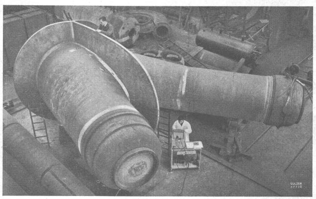
Teilpartie einer Verteilleitung, ausgerüstet mit Sulzer-Kragenverstärkung, bei der Druckprobe im Werk. Lichtweite des Verteilstückes 2,7 / 2,35 / 1,4 m
