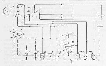
Prinzipielles Schaltschema einer Dampfturbinenanlage mit Zwischenüberhitzung und sechsstufiger Speisewasservorwärmung, sowie teilweiser Kondensat-Rückkühlung
