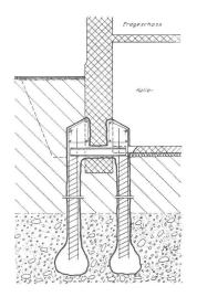
Unterfangung mit Betonbohrpfählen
