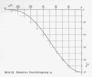
gestellt. Die effektiven Durchbiegungen sind  $p\,\mu$  mal grösser. Da für x=0  $y_1=1$  gesetzt wurde, stellen die  $p\,\mu$ -Werte direkt die Scheiteldurchbiegungen  $y_0$  in Funktion des Winkels  $\alpha$  dar. Diese Relation geht aus Bild 13 hervor.
