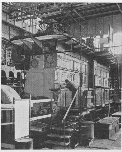
Bild 2. Ansicht von Spülpumpenseite. 1 Geschwindigkeitsregler, 2 Verschalung zum Kettenantrieb der Steuerwelle, 3 Lufteinsaugdüsen zu den Spülpumpen
