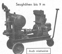
Leistungen 1—500 I/sek. Kein Bodenventil. Keine Klappe im Saugstutzen. Keine Hilfs-Vakuum-Pumpe. Jederzeitiges automatisches Ansaugen auch nach Lufteintritt im Saugrohr. Keine reibenden, sich abnützenden Dichtungsflächen, daher störungsfrei auch bei Schlamm-, Sand- und Kiesförderung.
