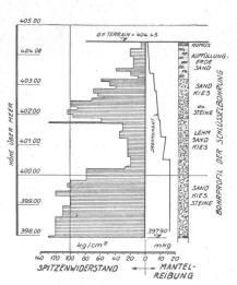
Diagramm einer Rammsondierung
