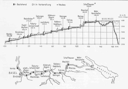
Bild 2, Ausbau der Rheinstrecke Basel—Bodensee; Plan 1:1 500 000, Längenprofil 1:1 500 000, Höhen 1:7500
