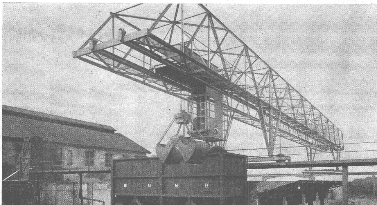
Verladebrücke in Schweisskonstruktion 2,5 t Tragkraft, 46 m Länge
