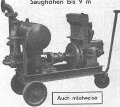
Leistungen 1-500 l/sek. Kein Bodenventil. Keine Klappe im Saugstutzen. Keine Hilfs-Vakuum-Pumpe. Jederzeitiges automatisches Ansaugen auch nach Lufteinfrift im Saugrohr. Keine reibenden, sich abnützenden Dichtungsflächen, daher störungsfrei auch bei Schlamm-, Sand- und Kiesförderung.
