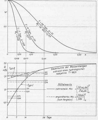
Bild 4. Bestimmung der wahrscheinlichen minimalen mittleren Wassermengen für die Zeitintervalle von 7, 14 und 28 Tagen aus der Dauerkurve der Wassermengen während eines hydrologischen Halbjahres
