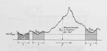
Bild 1. Ableitung des Begriffs der minimalen mittleren Wassermenge min  $Q_{mt}$  aus dem zeitlichen Verlauf der Wassermengenkurve  $Q_z$
