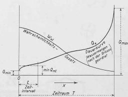
Bild 2. Ableitung der minimalen mittleren Wassermenge  $\min \, Q_{mt}$ aus der Dauerkurve  $Q_{x}$
