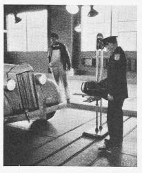
Bild 3. Scheinwerferprüfung.
