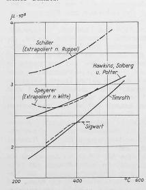
Bild 1. Zähigkeit von Wasserdampf bei 40 bar in  $\log s/m^2$  nach verschiedenen Forschern.
