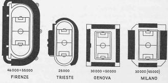
Bild 7. Grundrisse und Fassungsvermögen verschiedener italienischer Stadien; die Zahlen geben das Fassungsvermögen zur Zeit der Erstellung an [3].
