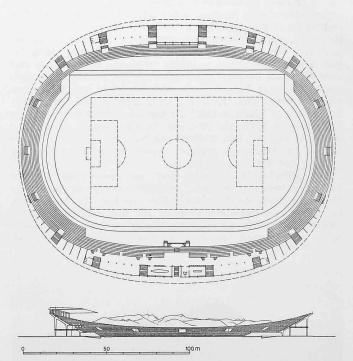
Bilder 11 bis 13. Stadion Pontaise in Lausanne, 1951, Ungleich hohe Zuschauertribünen, wodurch der Blick in die Berge über die Südkurve freibleibt, Arch. C. F. THEVENAZ. Masstab von Bild 13 1:1050,
