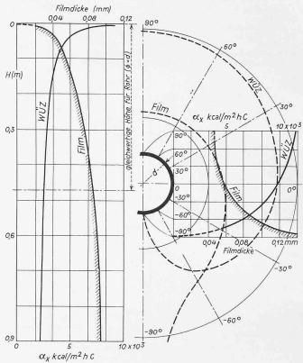
Bild 14. Wärmeübergangszahl und Filmdicke bei gleichbleibendem Wert  $\varDelta t$  bei laminarem Filmablauf, links für eine vertikale Wand, rechts für ein liegendes Rohr.
