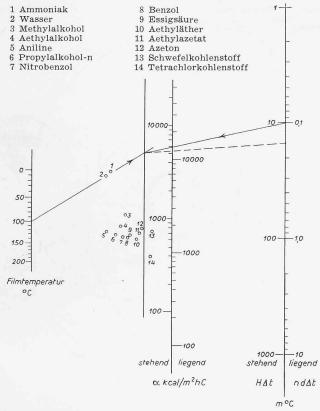
$\operatorname{Bild}$ 9, Nomogramm nach Schema B, gültig für verschiedene Dämpfe und laminaren Film.
