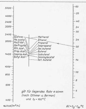
Bild 10. Sonderdiagramm nach Schema A für liegende Rohre von etwa 50 mm Durchmesser für verschiedene Dämpfe. Eingetragenes Beispiel: Methanol, liegendes Rohr, d=45 mm,  $t_f=100^{\circ}$  C,  $\Delta t=20^{\circ}$ , gibt  $\alpha_m=2370$  kcal/m² ho C.
