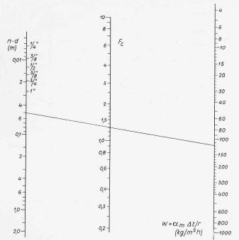
Bild 13. Nomogramm für liegendes Rohrbündel und die auf Tabelle 2 angegebenen Dämpfe, Eingezeichnetes Beispiel: Wasserdampf  $t_f=120^0$ , nd=0.05 m, W=116 kg/m² h; nach Tabelle 2 ist F (t) = 9850; aus Bild 13 folgt  $F_c=1.3$ ; damit wird  $\alpha_m=9850$ . 1.3=12800 kcal/m² h°C.
