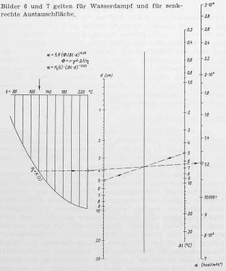
Bild 8, Nomogramm für Wasserdampf für liegende Rohre mit laminarem Abfluss, Eingezeichnetes Beispiel: Wasserdampf, horizontales Rohr, laminarer Film,  $d=50\,$  mm,  $\Delta t=50\,$  C,  $t=1800\,$  C gibt  $\alpha_m=12\,200\,$  kcal/m² h³ C.
