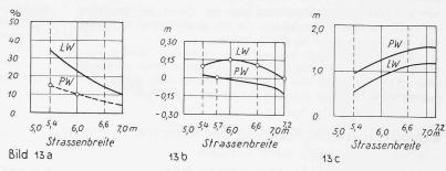
Bild 13a. Verhalten der freibeweglichen Fahrzeuge (geringer Verkehr). Anteil der Fahrzeuge in Prozent, die teilweise in die linke Spur fahren in Abhängigkeit von der Strassenbreite (Amerikanische Beobachtungen).
