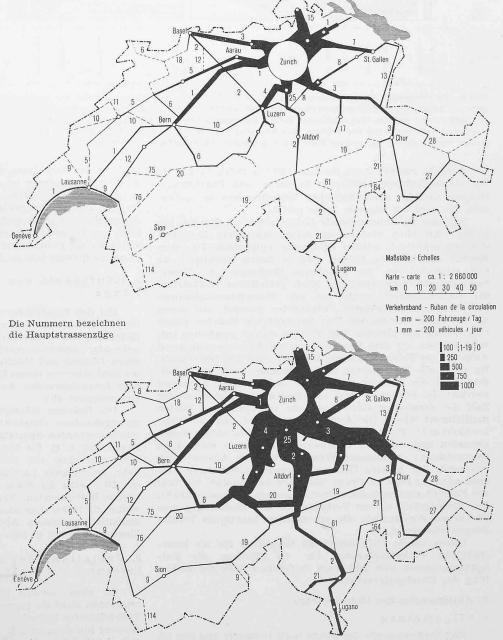
Bild 6. Inanspruchnahme des schweizerischen Hauptstrassennetzes durch Zürcher Automobile, oben an einem Werktag (9. Juli 1948) unten an einem Sonntag (22. August 1948). Die Breite des Verkehrsbandes entspricht dem Tagestotal. Das Bild ist eine Art Momentaufnahme des Zürcher Verkehrs. Der Sonntagsverkehr ist vor allem gegen das Alpengebiet gerichtet.
