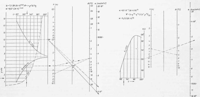
Bild 6. Nomogramm bei laminarem Abfluss. Eingezeichnetes Beispiel: Wasserdampf, vertikales Rohr, laminarer Abfluss, H=4 m, 4t=50 C, t=2000 C gibt  $\alpha_m=5300$  kcal/m² h² C.
