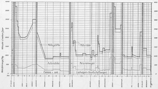
Bild 5. Verkehrsprofil der Hauptstrasse Nr. 1/7, Genf - Lausanne - Bern - Zürich - Winterthur - St. Gallen. Das Profil zeigt das Jahresmittel des täglichen Verkehrs, unterteilt in Motorradverkehr, Personenautoverkehr und den die Verkehrskoordination interessierenden Schwerverkehr (Lastwagen und Cars).
