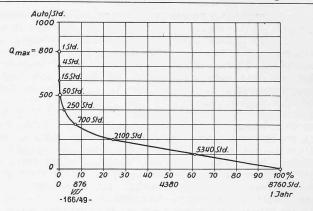
Bild 2a. Dauerkurve des Verkehrs während eines Jahres (8760 Stunden). Die Dauerkurve zeigt, an wievielen Stunden im Jahre eine bestimmte Verkehrsmenge erreicht oder überschritten wird; Beispiel aus Amerika, konstruiert auf Grund der Ergebnisse automatischer Verkehrszählungen.
