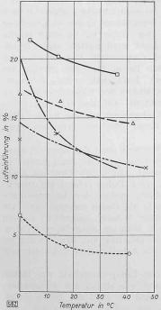
Bild 10. Luftporeneinführung in Mörtel 1:4 bei Temperaturen von 00 bis 400 C ohne Zusatz und mit vier verschiedenen Zusätzen
