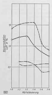
Bild 14. Anmachwasserverminderung in % pro % Luftporeneinführung in Abhängigkeit von der Mörteldosierung, Legende der Zusatzmittelsymbole siehe bei Bild 8
