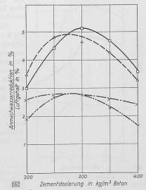
Bild 12. Verminderung des Anmachwassers in % bzw. in % pro % eingeführte Luftporenmenge in Betone verschiedener Dosierung. Zeichenerklärung siehe Bild 8 in Nr. 1, S. 11
