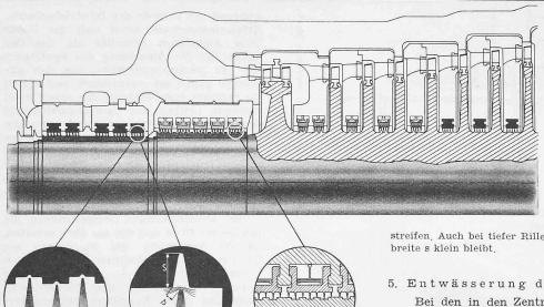
an der oberen Gehäusehälfte gerade Pratzen als Verlängerung der Teilflanschen angegossen, die sich auf entsprechende Konsolen am Abdampfstutzen der Niederdruckturbine abstützen. Die untere Hälfte des Hochdruckgehäuses hängt demnach an den Teilflanschbolzen; beim Lösen dieser Bolzen zwecks Kontrolle des Turbineninnern werden deshalb unter die Stützflächen B der kurzen Tragpratzen der unteren Gehäusehälfte besondere Montagekeile eingeschoben.
