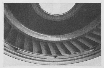
Bild 10. Fangtaschen am Umfang eines Niederdruck-Leitrades zur Ableitung der von den Laufschaufeln wegfliegenden Wassertropfen
