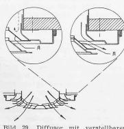
Bild 29. Diffusor mit verstellbarem Ringdeckel A zur Veränderung des Wurfradius, links Deckel A zu, rechts
