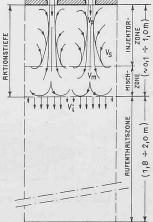
e) Perforierte Decken Die Luftverteilung durch Doppeldecken mit gelochter
