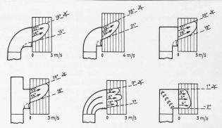
Bild 14. Geschwindigkeitsprofile an Zuluft-Austrittsöffnungen bei verschiedener Art der Luftzuführung. Kanalquerschnitt  $350\times150$  mm, Auslassquerschnitt  $350\times225$  mm, Luftgeschwindigkeit im Kanal 2,5 m/s, Luftmenge 470 m³/h.
