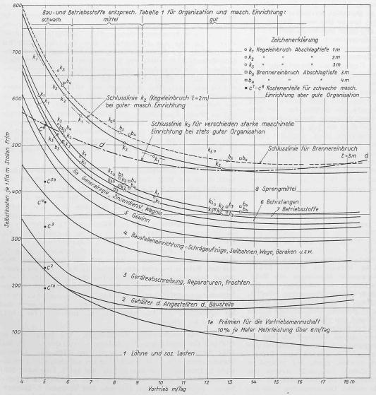
Bild 31. Selbstkosten eines Stollens als Funktion der täglichen Vortriebsleistung (nach Rabcewicz),  $F = 8 \text{ m}^2$ , L = 4.5 km, Gneis
