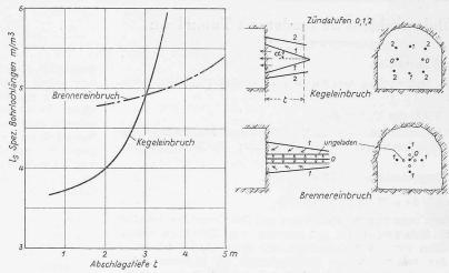
Bild 22. Spezifische Bohrlochlängen als Funktion der Abschlagtiefe (Rabcewicz) Stollen  $F=8~{\rm m^2}$ , Gneis, Gelatine Aldorfit A
