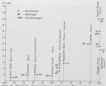
Bild 30. Wirkliche Bohrleistungen bekannter Tunnelarbeiten, V in m Bohrloch/1 Maschine/h, alle Nebenleistungen inbegriffen (nach Rabcewicz)
