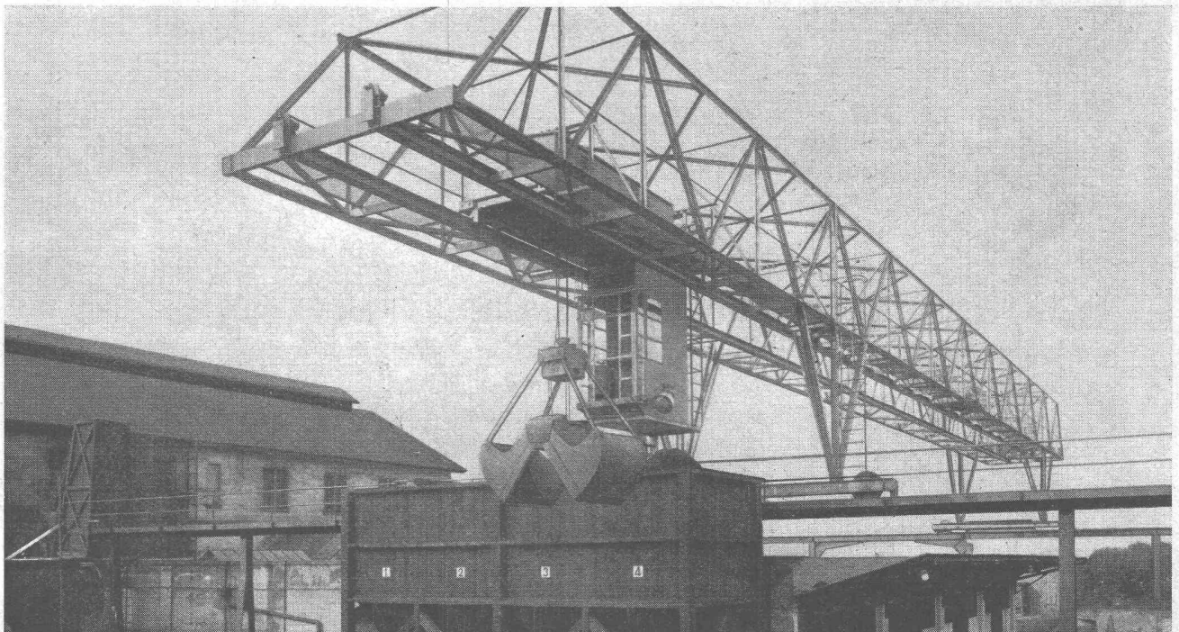
Verladebrücke in Schweisskonstruktion 2,5 t Tragkraft, 46 m Länge
