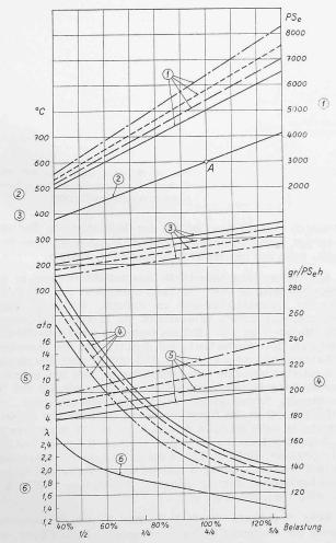
Bild 24. Büchi-Brennkraft-Gasgenerator-Gasturbine Betriebsvoraussetzungen:
