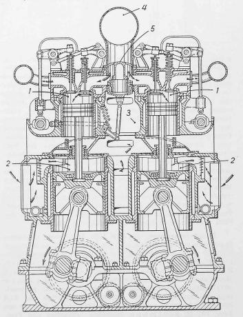
$\operatorname{Bild}$ 25. Querschnitt durch Büchi-Viertakt-Brennkraft-Gasgenerator für Gasturbine
