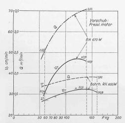
Bild 13. Beziehung zwischen der reinen Bohrgeschwindigkeit  $v_r$  bzw. dem Luftverbrauch Q und dem reinen Anpressdruck P
