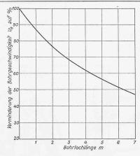
Bild 21. Abnahme der Bohrleistung mit der Lochlänge. Mittelwert aus Ver-
