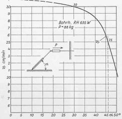
Bild 14. Beziehung zwischen Bohrgeschwindigkeit und Stützwinkel am Bohrknecht
