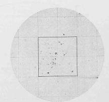
Bild 2a. Raumluft eines Fabriklokals Bild 2b. Aussenluft in Bodenhöhe Bild 2c. Aussenluft auf Dachhöhe Konimeteraufnahmen des Staubes von ½ l Luft, Vergrösserung 100fach. Untersuchungen des Verfassers.
