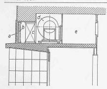
Bild 6 (links). Frisehluftaggregat, über dem Windfang angeordnet. a verstellbare Jalousien Filter, c Lufterhitzer, d Ventilator, e Verteilkammer.
