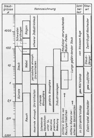
Bild 1, Klassierung der Unreinigkeiten in der Atmosphäre (1  $\mu=$  1/1000 mm)
