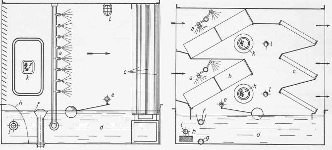
Bild 11. Luftwäscher für einen Luftdurchsatz von rd. 20 000 m<sup>3</sup>/h, Masstab 1:20
