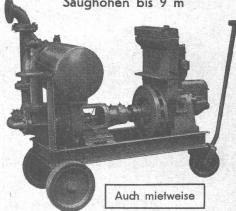
Leistungen 1-500 l/sek. Kein Bodenventil. Keine Klappe im Saugstutzen. Keine Hilfs-Vakuum-Pumpe. Jederzeitiges automatisches Ansaugen auch nach Lufteintritt im Saugrohr. Keine reibenden, sich abnützenden Dichtungsflächen, daher störungsfrei auch bei Schlamm-, Sand- und Kiesförderung.
