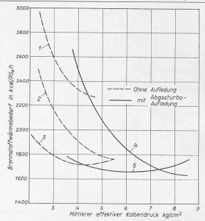
Bild 15. Brennstoffwärmebedarf verschiedenartig arbeitender Gasund Dieselmotoren
