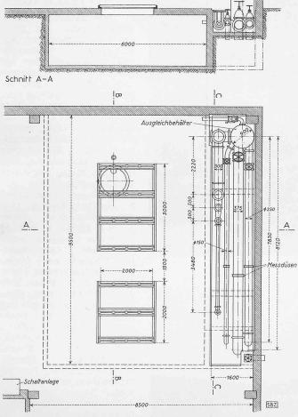
Von den Messleitungen strömt das Wasser wieder in den Behälter zurück und wird so in ständigem Kreislauf gefördert. Für längere Vertikalpumpen oder für Saugversuche ist ein besonderer Schacht von 9,5 m Tiefe gebaut worden. Bei Kavitationsversuchen wird das Wasser im grossen Behälter bis auf die Höhe des Blechzylinders abgesenkt, worauf mittels Drosselung am Rückführschieber jede beliebige Saugtiefe eingestellt und gehalten werden kann.
