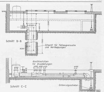
Bilder 8 und 9. Pumpenprüfstand, Grundriss und Schnitte, Masstab 1:125
