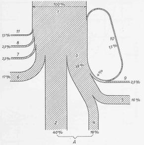
Bild 12. Wärmebilanz für einen Dieselmotor mit Abgasturboaufladung und Abwärmedampferzeuger
