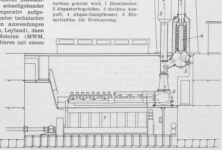
Bild 11. Schiffsdieselmotor mit Ab-
