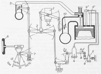
Bild 13. Regulierschema eines Worthington-Zweistoff-Gasmotors (Dual-Fuel Engine) mit Abgasturboaufladung
