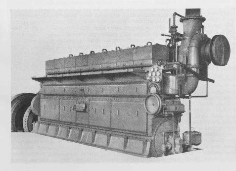
Bild 14. 1800 PSe-Zündöl-Gasmotor mit Abgasturboaufladung der Worthington Pump & Machinery Corp., Buffalo. 8 Zylinder, 406,4 mm Zylinderbohrung, 508 mm Kolbenhub, 1800 PSe bei 360 U/min.
