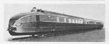
Bild 10. Schnelltriebwagenzug der Deutschen Reichsbahn, angetrieben durch zwei Maybach-Dieselmotoren mit Abgasturboaufladung.  $2\times12$  Zylinder, 160 mm Bohrung, 200 mm Hub,  $N_e=600$  PS bei 1400 U/min.
