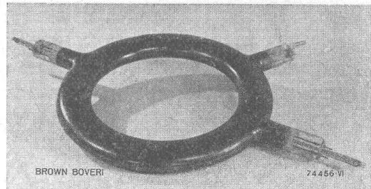
Bild 2. Betatron-Kreisröhre mit zwei Elektronenspritzen und einem Stutzen für das Getter. Die evakuerte Röhre muß einem Druck von 7 t standhalten
