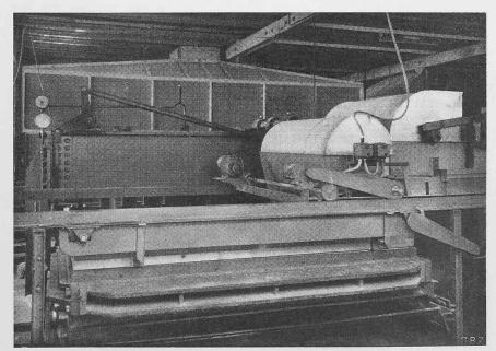
Bild 5. Formmaschine, dahinter die Vorpresse.
