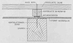
Bilder 4 bis 6. Arbeitsvorgang und Konstruktionsdetail 1:6 für Dächer der 2. Stufe, 190 bis 270 mit Lattung und Konterlattung und Pfannenziegeln, Fugen mit Bitumenstreifen gedeckt.
