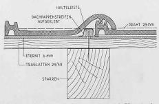
Bilder 1 bis 3. Arbeitsvorgang und Konstruktionsdetail 1:6 für Dächer der 1. Stufe, 80 bis 180 Neigung, ohne Lattung mit Pfannenziegeln, Fugen überdeckt und geklebt.
