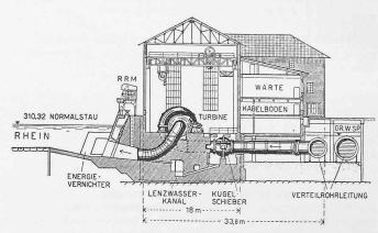
Bild 5. Querschnitt durch die Zentrale Waldshut, 1:750 RRM Rechenreinigungsmaschine
