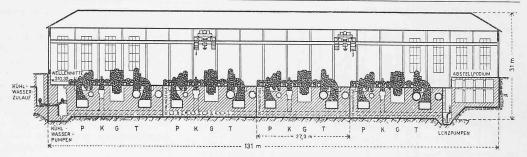
Bild 4. Längsschnitt durch die Zentrale Waldshut, P Pumpe, K Kupplung, G Generator, T Turbine
