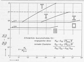
Bild 8. Verhältnis der erforderlichen Querschnittshöhe eines vorgespannten zu derjenigen eines normalen Eisenbeton-Querschnittes, wenn beide durch die gleichen Momente  $M_P$  und  $M_g$  beansprucht sind.
