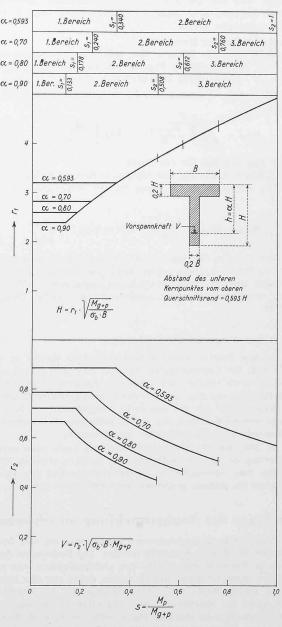
Bild 7, Einfluss der Exzentrizität der Vorspannkraft auf die Dimensionierung eines Plattenbalkens.
