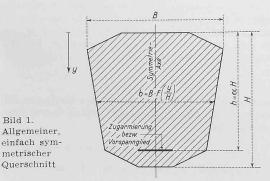
Bild 3. Bezeichnungen für die Querschnittswerte
