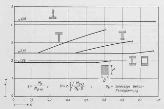
Bild 5. Koeffizienten  $r_1$  zur Bestimmung der Querschnittshöhe H
