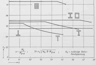
Bild 6. Koeffizienten  $r_2$  zur Bestimmung der Vorspannung V
