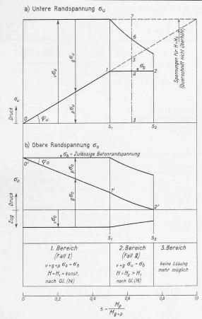
Bild 4. Randspannungen eines vorgespannten Querschnittes, wenn  $M_g + p = \text{const.}$  und  $s = M_p / M_g + p$ veränderlich ist
