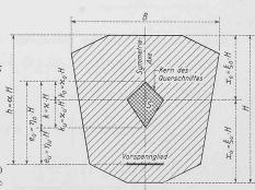
Es ist nun ohne weiteres verständlich, dass die Ungleichung (6) auf alle Fälle in eine Gleichung umgewandelt wird, denn es besteht kein Grund dafür, die Vorspannung über das Mass zu erhöhen, das notwendig ist, um die untere Randspannung beim ungünstigsten Belastungsfall gerade null werden zu lassen. Dadurch ergeben sich die folgenden drei Kombinationsmöglichkeiten:
