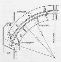
Bild 1. Horizontalschnitt durch die Eisenbetonschütze des Stauwehrs Rivières am Tarn
