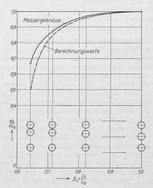
Bild 14. Vergleich zwischen theoretisch und experimentell ermittelten Wärmeübergangszahlen in Funktion der Ungenauigkeit in der Rohrteilung bei Querstrom.
