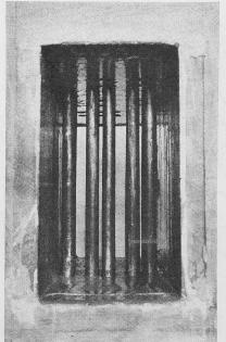
Bild 10. Rohrbündel mit ungenauer Teilung.
