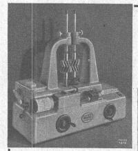
Achsdistanz- und Rundlaufprüfgeräf, Typ DAS-10, für Stirn- und Schraubenräderpaare bis 120 mm Achsdistanz.
