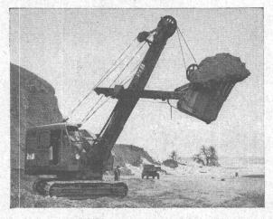
Löffelbagger mit Tru-Lay-Brugg-Drahtseilen ausgerüstet
