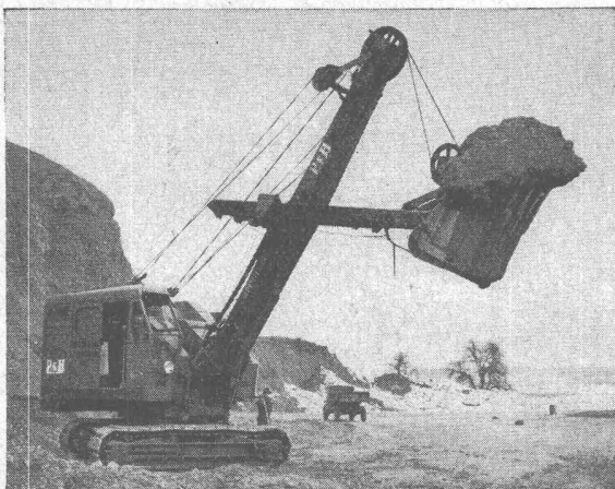
Löffelbagger mit Tru-Lay-Brugg-Drahtseilen ausgerüstet
