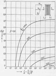
Bild 2. Verminderung der übertragenen Wärmemenge gleichmässiger Geschwindigkeit bei Querstrom mit fluchtender Anordnung der Rohre
