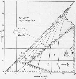
Bild 7. Verminderung der übertragenen Wärmemenge infolge ungenauer Rohrteilung bei Querstrom mit fluchtender Anordnung der Rohre
