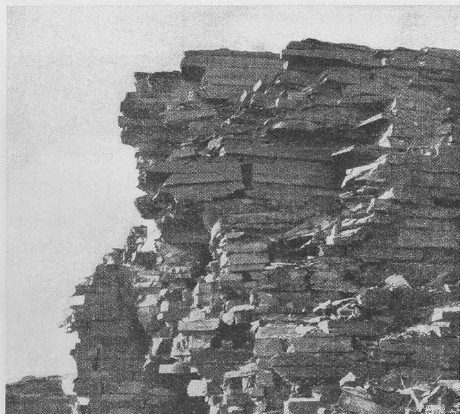
Bild 2. Schieferbruch. Das Material wird als Brennstoff für das Brennen des Kalksteines verwendet. Daraus entstehen Schieferasche und gebrannter Kalk.
