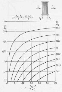
Bild 5. Beziehung zwischen übertragener Wärmemenge und Wärmeübergangszahl
