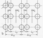
Bild 6. Rohranordnung bei Querstrom
