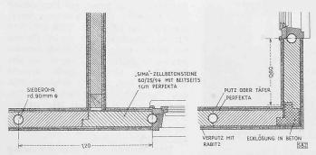
Bild 10. Einzelheiten der Sima-Bauweise, Horizontalschnitte 1:30
