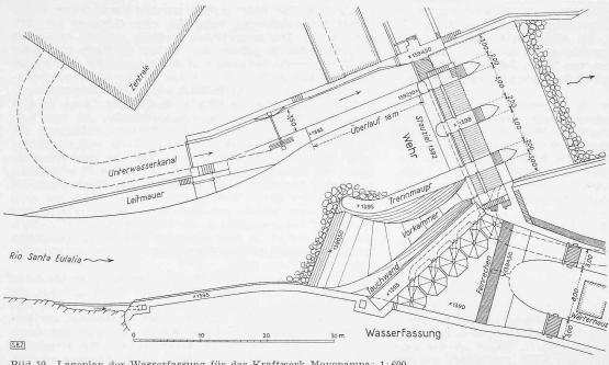
Bild 10. Lageplan der Wasserfassung für das Kraftwerk Moyopampa; 1:600,
