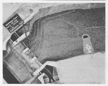
Bild 4, Modell der Wasserfassung des Aletschwerkes, Auflandungen im Oberwasser und Kolk vor der Fassung bei Durchfluss von 60,0 m³/s.
